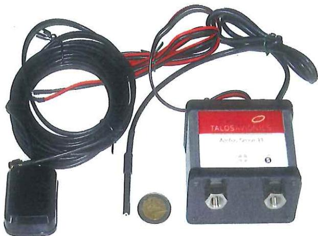
Moderniser la planche de bord de son avion de construction amateur pour quelques centaines d'euros, c'est ce que vient de faire **Yves Leipert** en s'équipant d'un AHRS\* pour tablette et téléphone, simple à monter, développé par la société grecque Talos Avionics du professeur Pantelis Georgiadis.
